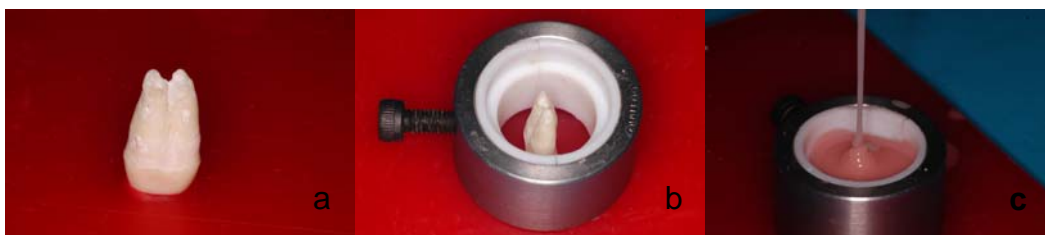
Figura 6 - a) dente fixado na cera; b) matriz cilíndrica posicionada em volta do dente; c) vazamento de resina acrílica dentro da matriz.
