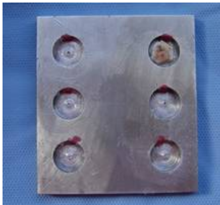
Fig. 8 – Moldeira de Aço Inoxidável com espaços negativos capazes de incluir 6 espécimes em acrílico ao mesmo tempo.
