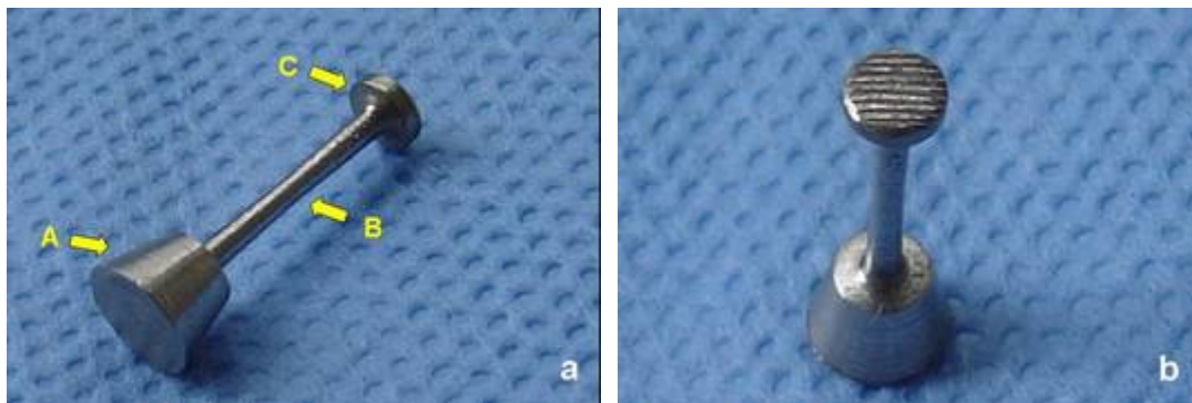
Fig.7 (a,b) – a – componentes do Pino de Tracionamento; b – ranhuras inferiores da Base Cilíndrica.
