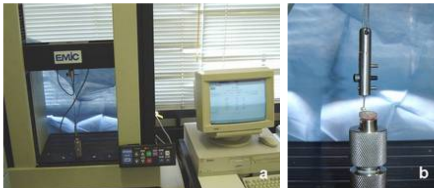
Fig.11 (a,b) – a - Peça posicionada para o teste de tração; b - enxerto aderido ao Pino de Tracionamento, após seu arrancamento do osso receptor mandibular.
