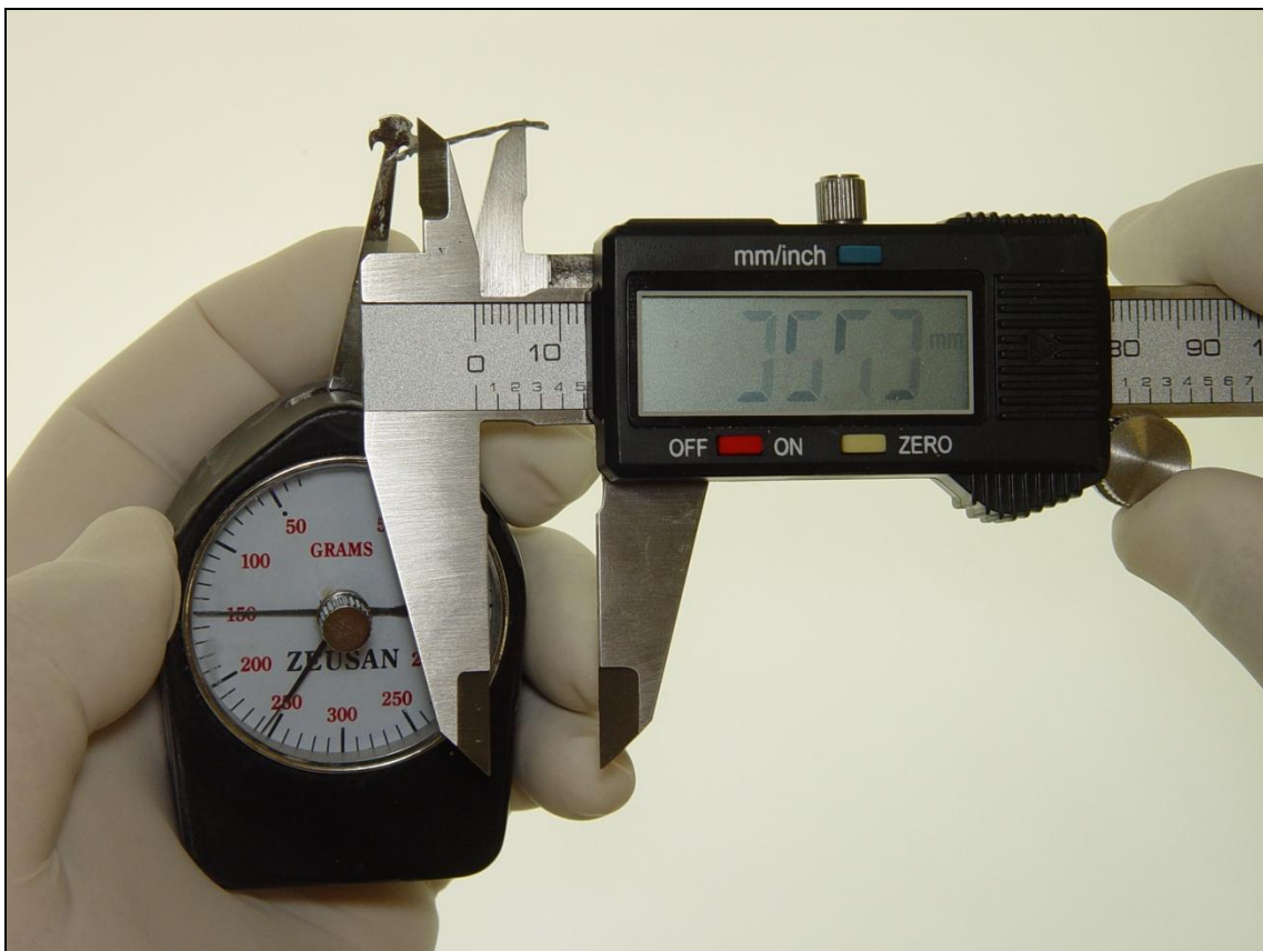
Figura - Determinação da distância necessária para atingir a força inicial de 150 gamas. Fonte: dados da pesquisa PUC 2009.
