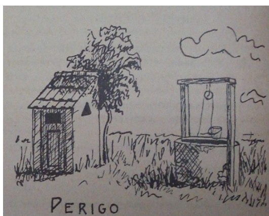
Imagem 15 – Perigo da construção de poço perto de latrinas Fonte – P.H. de São Jerônimo, n. 3, jan. 1940, p. 2.
