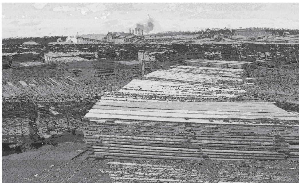
Figura n. 40: Técnica de empilhação
