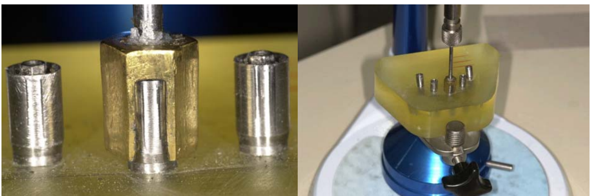
Figura 11 – Dispositivos usado para padronizar o posicionamento dos extensômetros nos pilares (esquerda).
