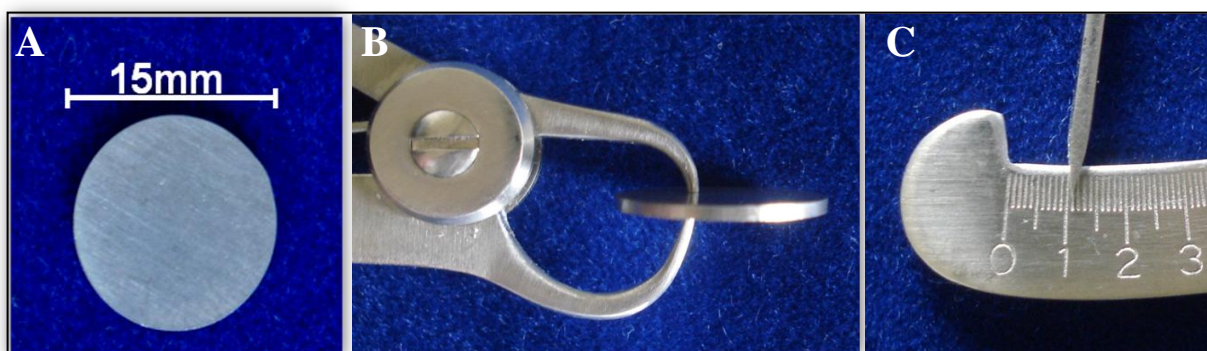
Figura 1 - Discos de titânio: A. Diâmetro de 15mm; B e C. Espessura de 1mm, medida através de espessímetro.
