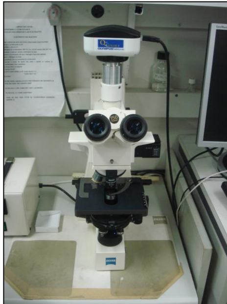
Figura 3 - Microscópio óptico conectado a um computador, utilizado para realização das imagens para contagem celular.
