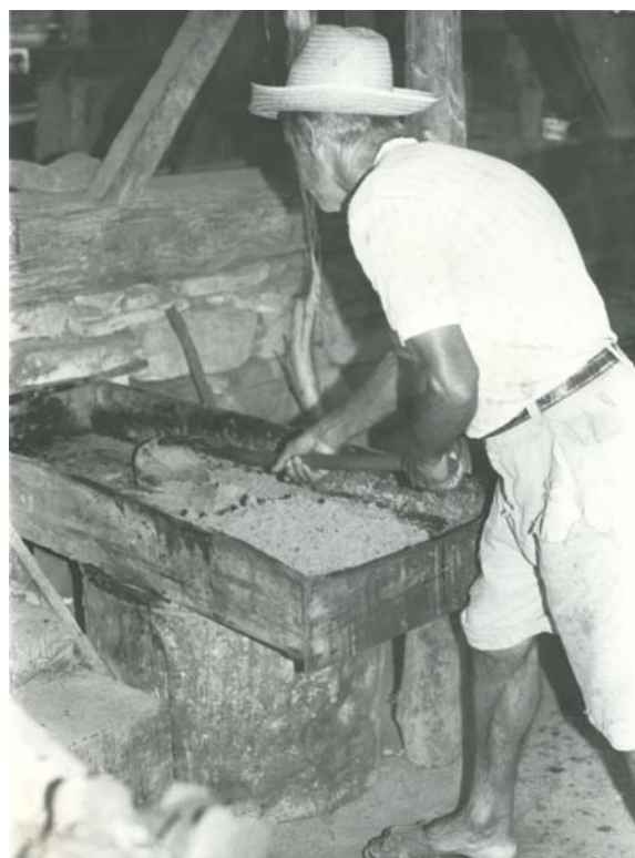
Fotografias 4 e 5 – Melado sendo esfregado com enxada, transformando-se em açúcar “esfregado” ou mascavo – década de 1980. Santo Antônio da Patrulha
