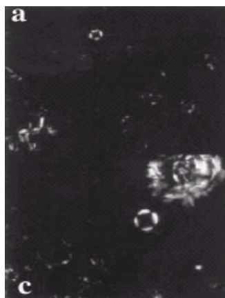
Figura 17 - Emulsões com óleo de pêssego contendo fases lamelares líquidas cristalinas. Fotomicrografia com luz polarizada.
