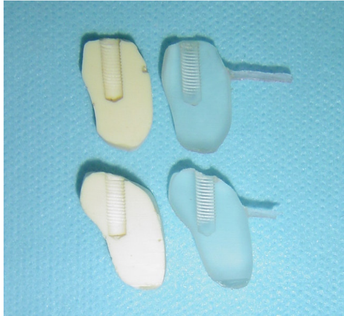
Figura 16 - Leitos dos implantes observados após o corte das mandíbulas no plano das hastes metálicas. Fonte: Dados da pesquisa.
