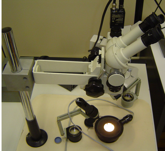
Figura 17 - Estereomicroscópio de iluminação transmitida e incidente com câmera de vídeo acoplada. Fonte: Dados da pesquisa.
