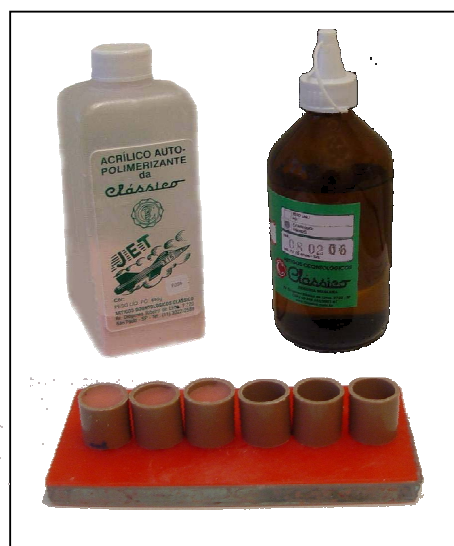
Figura 7 – Resina acrílica autopolimerizável utilizada no preenchimento dos anéis de PVC para a inclusão dos fragmentos vestibulares.
