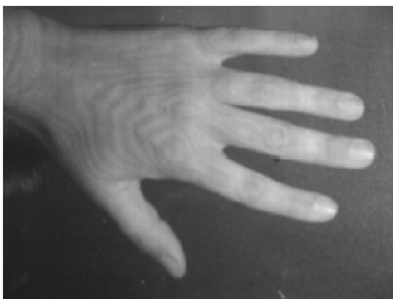
Figura 7 - Efeito de Moiré gerado no dorso da mão com retículo de 0,5mm x 0,5mm.
