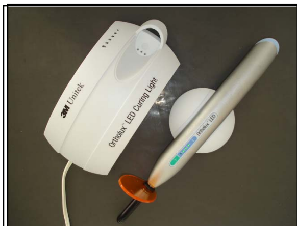
Figura 8 – Aparelho de fotopolimerização por Light Emitting Diode (LED).
