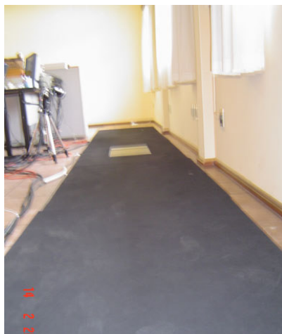
Figura 5 - Passarela e a plataforma de pressão EMED
