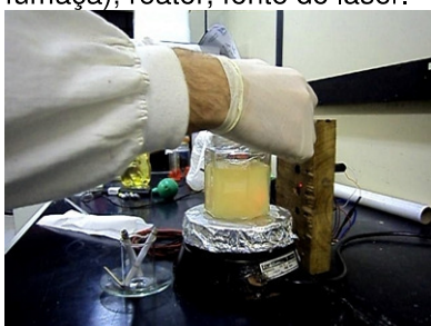
4- O reator é fechado com filme plástico.
