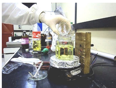
2- Adição da mistura catalítica (KOH em metanol) ao vaso de reação.
