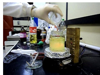
3- A mistura óleo + álcool torna a reação bastante pouco translúcida.
