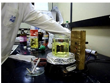
1- Montagem do experimento. Da esquerda para a direita tem-se, cigarros (para gerar fumaça), reator, fonte do laser.
