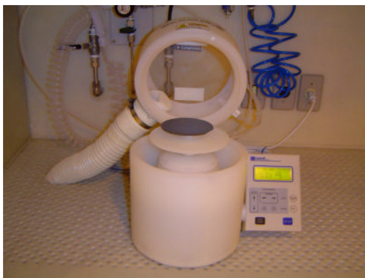
Figura 3.5. Spinner utilizado para deposição de líquidos dopantes e resina sobre a lâmina de silício.
