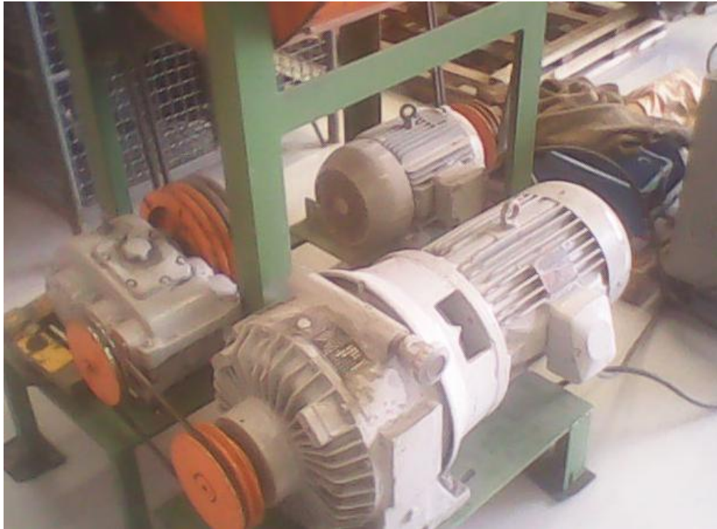
Figura 5.7. Motores de acionamento da bancada de testes.
