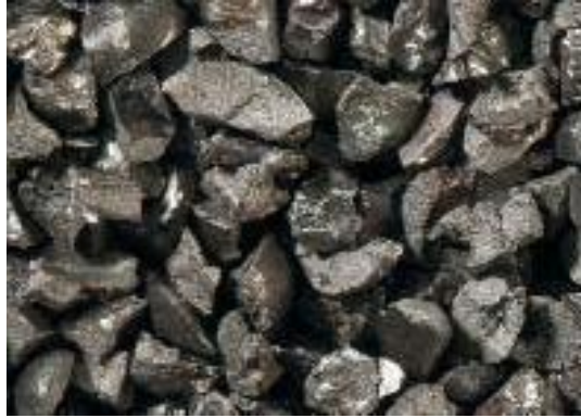
Figura 3.11. Granalha de aço angular (SINATORA, 2009).
