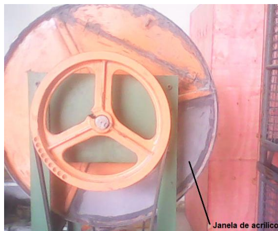
Figura 5.6. Janela de acrílico na lateral do tambor da bancada de testes
