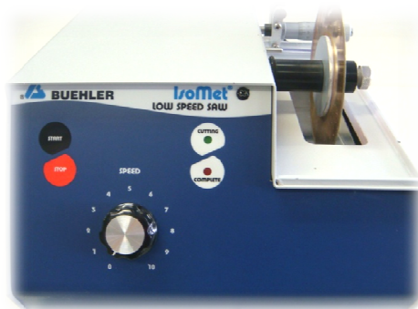
Figura 4.3. Fotografia da serra de corte com disco diamantado.
