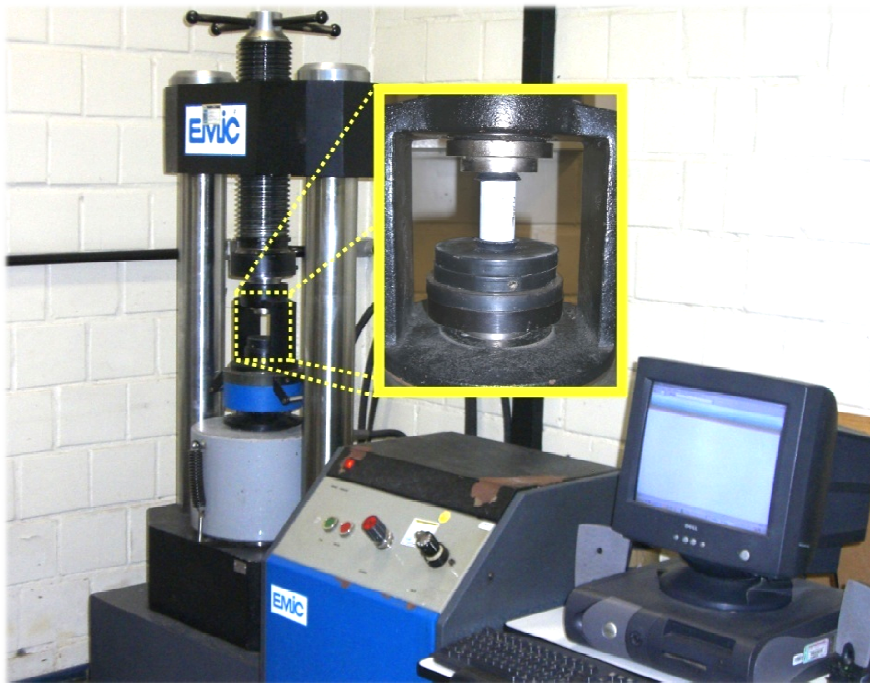
Figura 4.7. Máquina utilizada nos ensaios de resistência à compressão.
