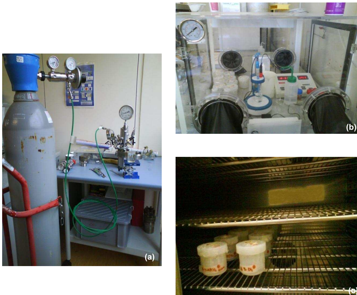
Figura 4.5. Reações a pressão atmosférica: (a) Purga na autoclave contendo a solução salina, (b) preparação dos reatores Savillex ® e (c) reatores Savillex ® dispostos na estufa a 80°C.
