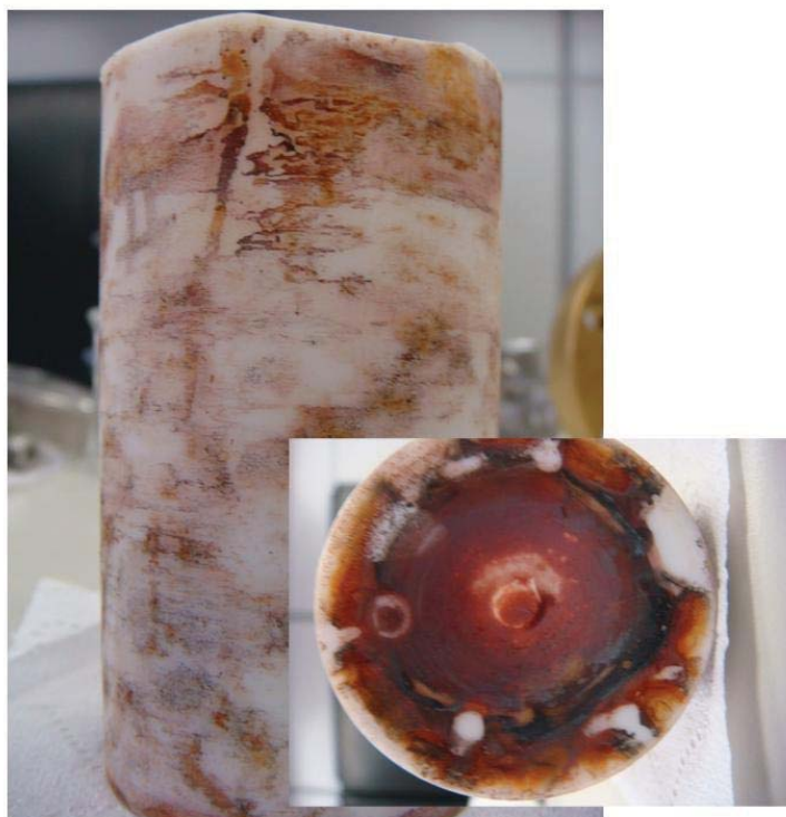
Figura 5.15: Corrosão copo de teflon após reação - detalhe fundo do copo -
