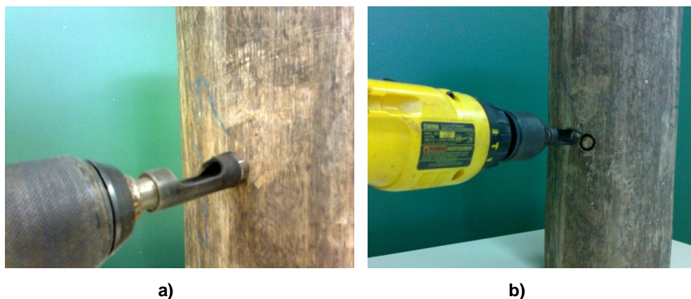
Figura 4.5. Método de amostragem não destrutivo utilizado para obtenção de baguetas de madeira de Eucalipto. Em a) Broca adaptada a um perfurador; e b) Bagueta obtida pelo método não destrutivo.
