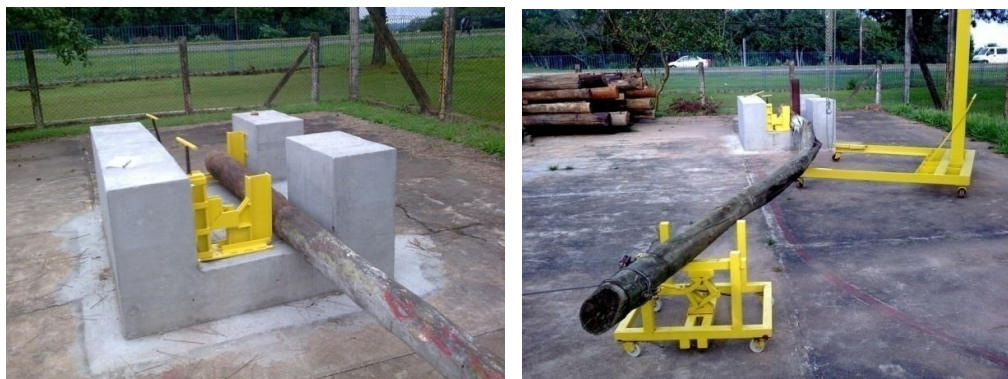
Figura 4.8. a) e b) – Teste de flexão de poste retirado da rede.
