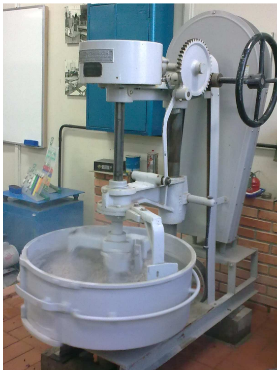
Figura 4.9: Betoneira utilizada para todas as dosagens.
