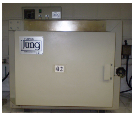
Figura 3.6. Forno resistivo tipo mufla, com controlador analógico com acionamento da potência por uma contatora, potência de 5 kW e atinge uma temperatura de 1200°C.
