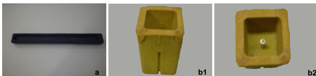
Figura 3.3. Moldes utilizados para vazamento dos lingotes e obtenção da curva de solidificação, (a) molde de grafite, (b1) e (b2) copo de análise térmica do tipo tec-tip.
