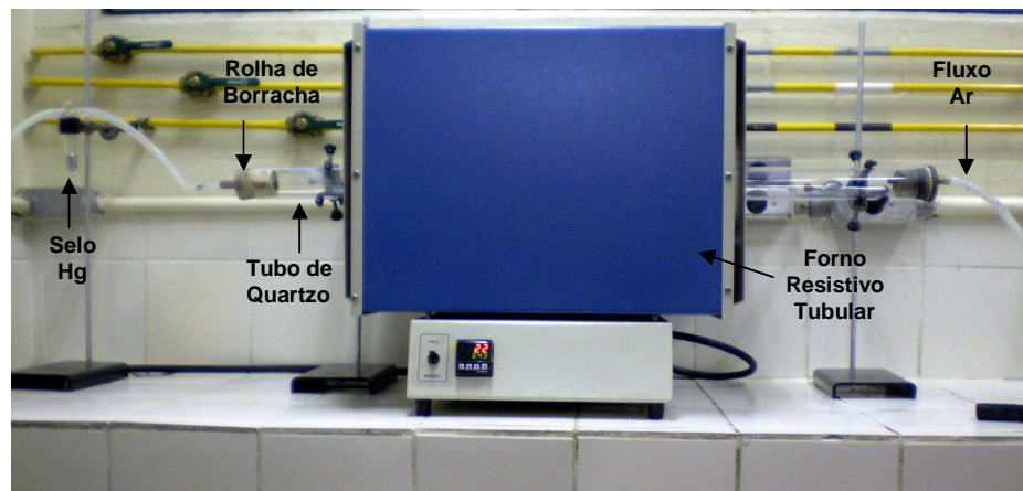
Figura 3.4. Forno tipo mufla, tubular, horizontal com câmara de quartzo, vedada lateralmente para fluxo de gás inerte. Um selo de mercúrio no fim da linha de gás impede o refluxo de oxigênio para o interior da câmara.
