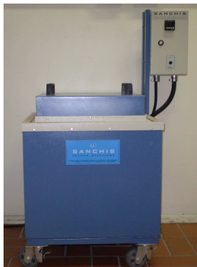
Figura 3.2. Forno resistivo tipo poço com controlador microprocessado modelo N480D potência de 4,3 kW com capacidade para cadinho de 4kg.
