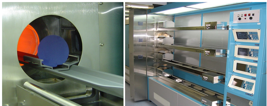
Figura 24. Forno convencional para difusão de dopantes e oxidação das lâminas.
