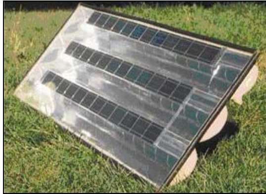
Figura 2.8. Módulo fotovoltaico concentrador estático com células solares bifaciais [35].
