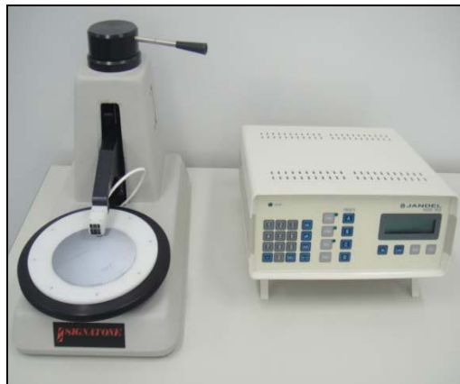
Figura 2.6. Estação de quatro pontas utilizada para medição da resistência de folha.
