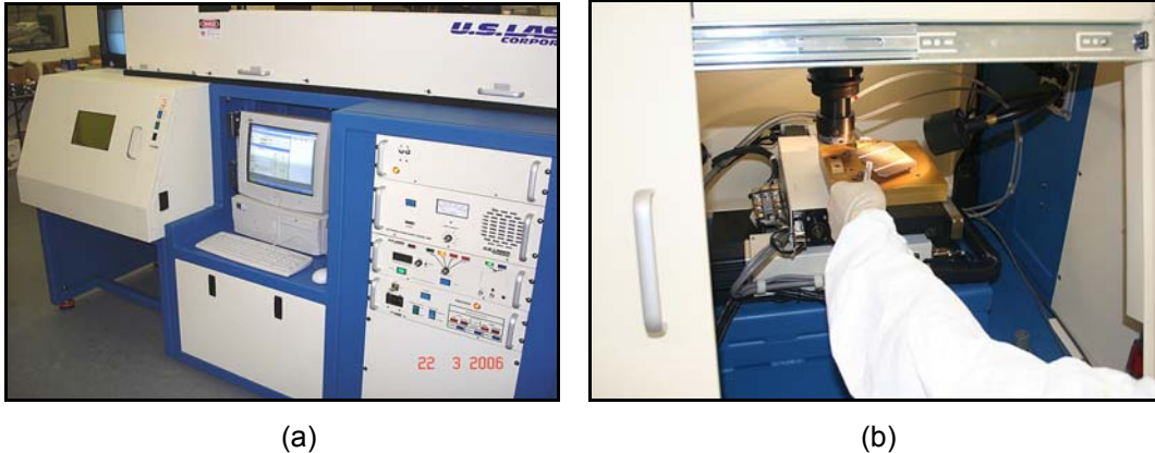
Figura 3.20. (a) Equipamento destinado à separação da região n^+ da p^+ nas bordas das lâminas de silício e (b) detalhe interno do equipamento.
