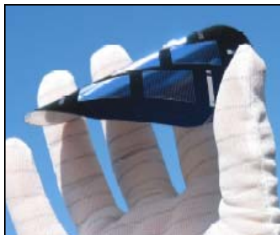
Figura 2.15. Fotografia de uma lâmina de silício fina e flexível com 42 \mu\text{m} de espessura e com células solares fabricadas [12].
