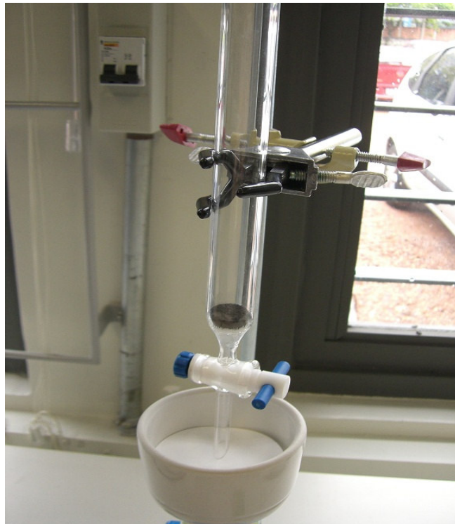
Figura 4.9. Montagem utilizada na extração em leito fixo.
