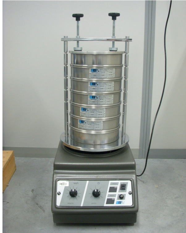
Figura 4.4. Peneirador vibratório e o conjunto de peneiras utilizado na separação das partículas.
