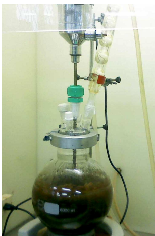
Figura 4.4. Extração de Cu, Cr e As com \text{H}_2\text{SO}_4 em reator de vidro e aquecimento em chapa elétrica
