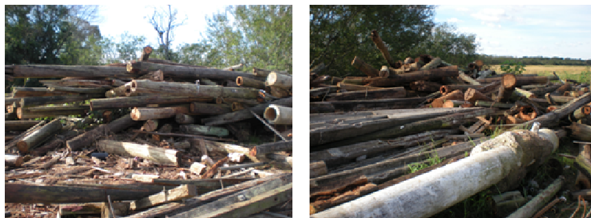
Figura 3.2. Postes tratados com CCA retirados de serviço (Empresa situada no RS).
