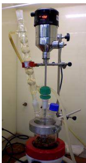
Figura 4.3. Extração de Cu, Cr e As com \text{H}_2\text{SO}_4 em reator de vidro e aquecimento em manta
