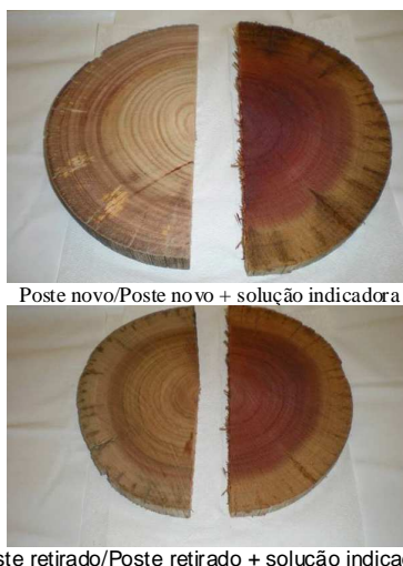
Figura 5.4. Teste colorimétrico para identificação do cerne e do alburno. Solução indicadora: cloreto de o-anisidina + solução de \text{NaNO}_2 .
