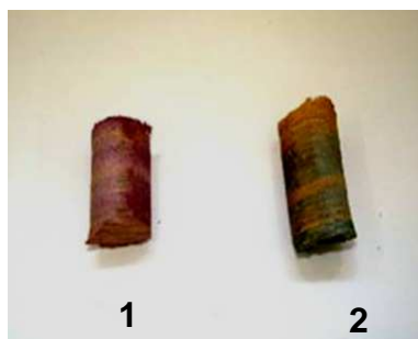
Figura 5.5. Teste colorimétrico para identificar a presença de Cu em poste de madeira (novo) tratado com CCA. Corante 1: PAN e corante 2: cromo azurol S.
