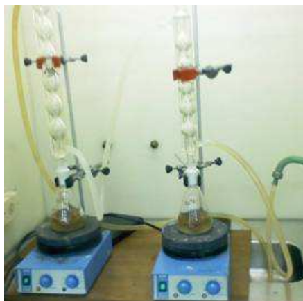
Figura 4.2. Extração de Cu, Cr e As com \text{H}_2\text{SO}_4 em frasco erlenmeyer e aquecimento em chapa elétrica
