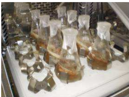
Figura 4.1. Frascos erlenmeyer contendo as amostras de madeira e o extrator dispostos sobre a mesa vibratória
