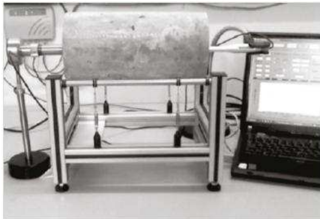
Figura 3.15. Aparato para o teste dinâmico em um corpo de prova cilíndrico (Diógenes e Cossolino, 2011).
