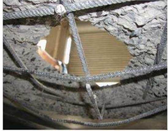
b- Altura de queda do martelo= 610 mm e malha de aço= 1 mesh
