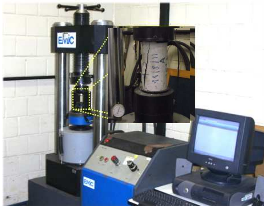
Figura 4.5. Fotografia da máquina utilizada para os ensaios de compressão (fotografia cedida por Martimiano Krusciel de Moraes e editada pelo autor).
