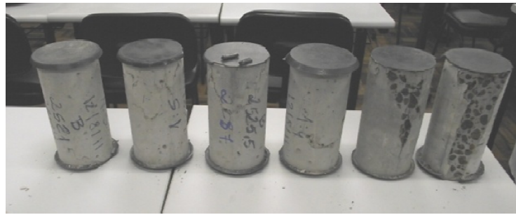
Figura 4.4. Fotografia dos corpos de prova utilizados para os ensaios de compressão simples.
