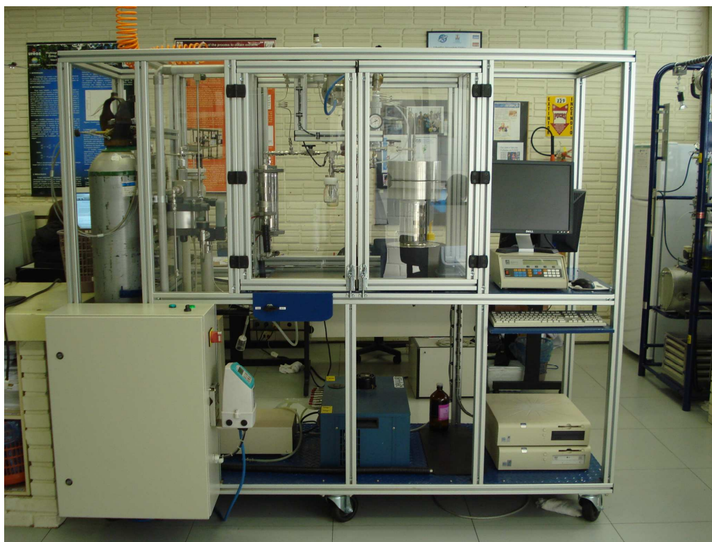
Figura 3.3. Unidade piloto de extração supercrítica. (Cassel et al., 2011).
