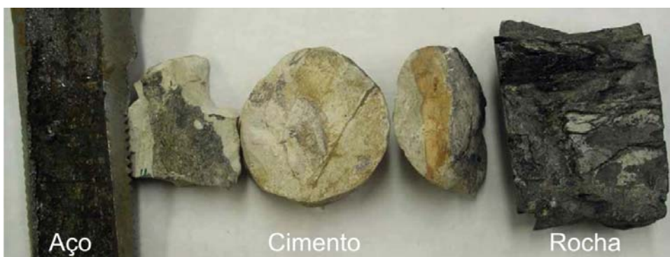
Figura 5-4: Testemunho de pasta de cimento extraído de um poço da unidade de Sacroc no Texas, EUA, o qual foi exposto ao CO 2 supercrítico por 30 anos (9).
