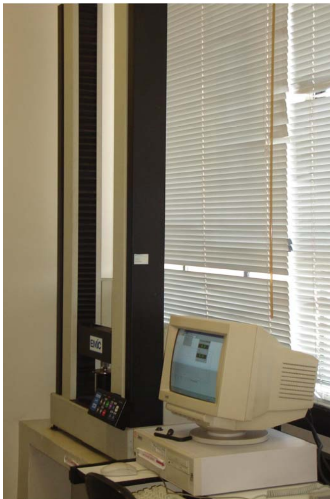
Figura 4 – Máquina de ensaio universal EMIC DL – 2000.
