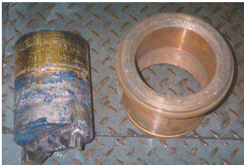
Figura 3.14. Lingote de Ni-Ti: 150mm de diâmetro por 200mm de comprimento e peso de 21.850g (à esquerda);- Cristalizador de cobre onde a liga Ni-Ti é solidificada (à direita) [Otubo, 2005].
