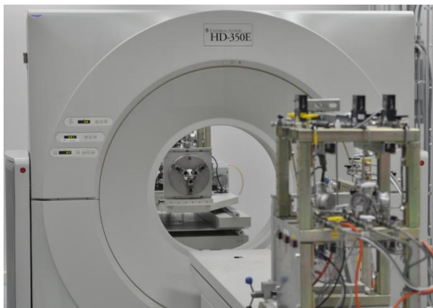
Figura 4.4: Tomógrafo computadorizado utilizado no imageamento das amostras de carvão confinadas.
