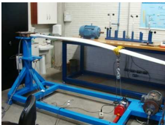
(a) Aplicação e medição de cargas
