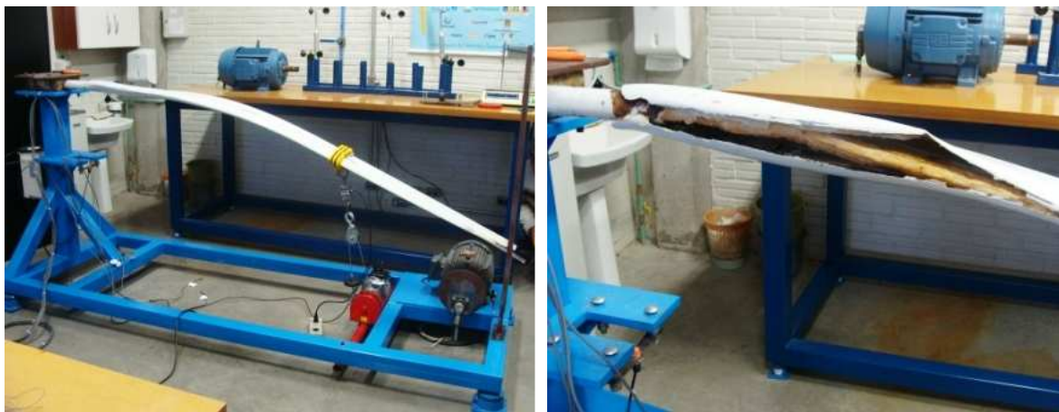
(a) Deflexão máxima antes da ruptura
