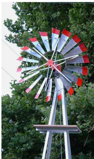
Figura 1.4. Moinho de bombeio americano, aproveitamento direto da energia mecânica para o bombeamento de água.
