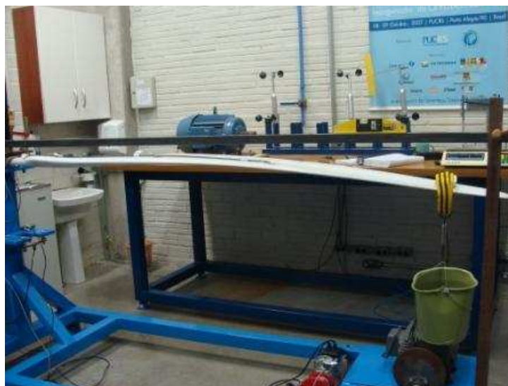
Figura 4.22. Medição de deslocamento devido a flexão.
