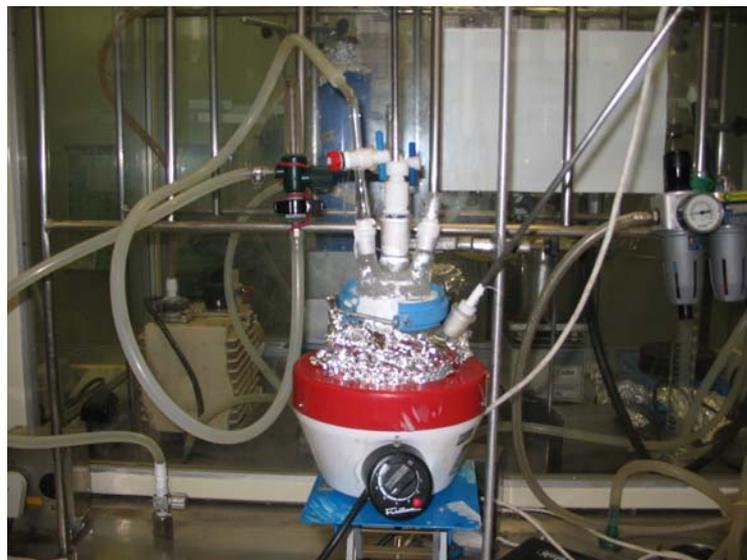
**Figura 4.2:** Montagem utilizada para a síntese do copolímero PET-co-PLLA.
