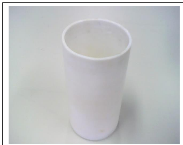
Figura 4.2. Copo de TEFLON ® utilizado para evitar corrosão do reator.
