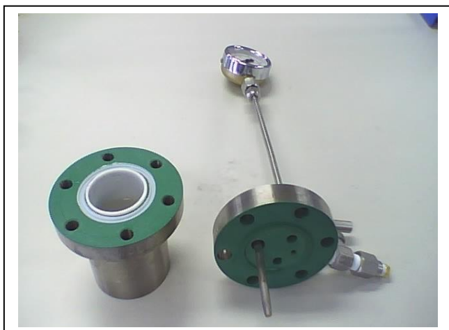
Figura 4.1. Reator utilizado para reações íons \text{Mg}^{2+} com \text{CO}_2 .
