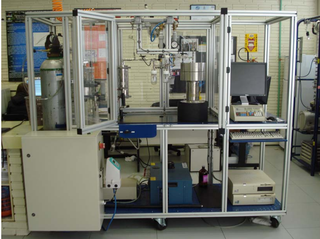
Figura 4.2. Unidade Piloto de Extração Supercrítica.
