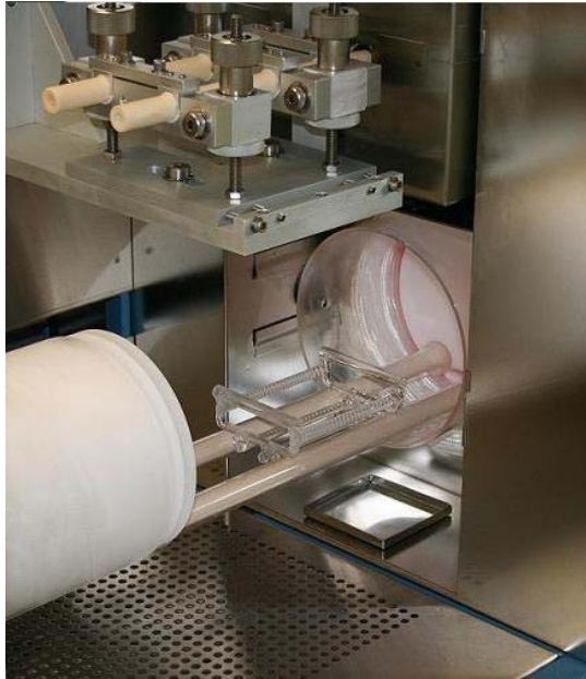
Figura 4.8. Detalhe do forno convencional para difusão de fósforo.
