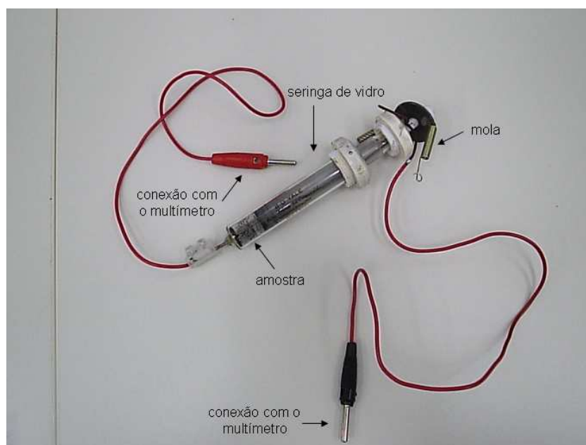
Figura 5.14. Dispositivo desenvolvido para medir a resistência das amostras.
