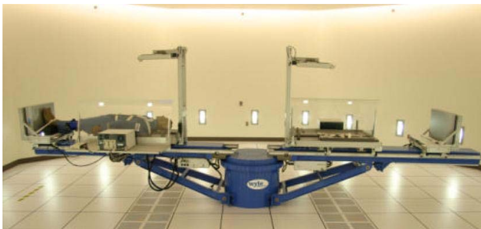
Figura 47 – Centrífuga de braço curto da NASA produzida pela Wyle. O braço possui dois braços de 3 metros de comprimento e pode atingir até 5G.
