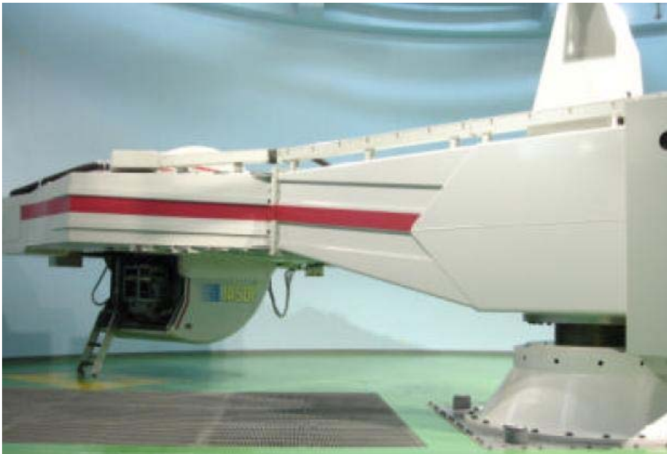
Figura 45 – Centrífuga japonesa JASDF (Japan Air Self Defense Force), braço com 7,62m, 6G/sec, +G Z máximo 12G, 9G é força utilizada para treinamento. Em torno de 200 pilotos treinados por ano (9).
