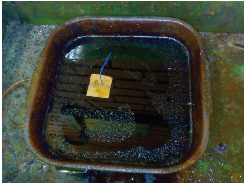
Figura 3.2.3: Placa de fenolite sendo corroída.
