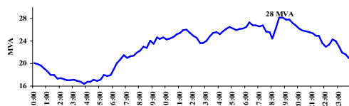
Fig. 4. Carregamento do Transformador
