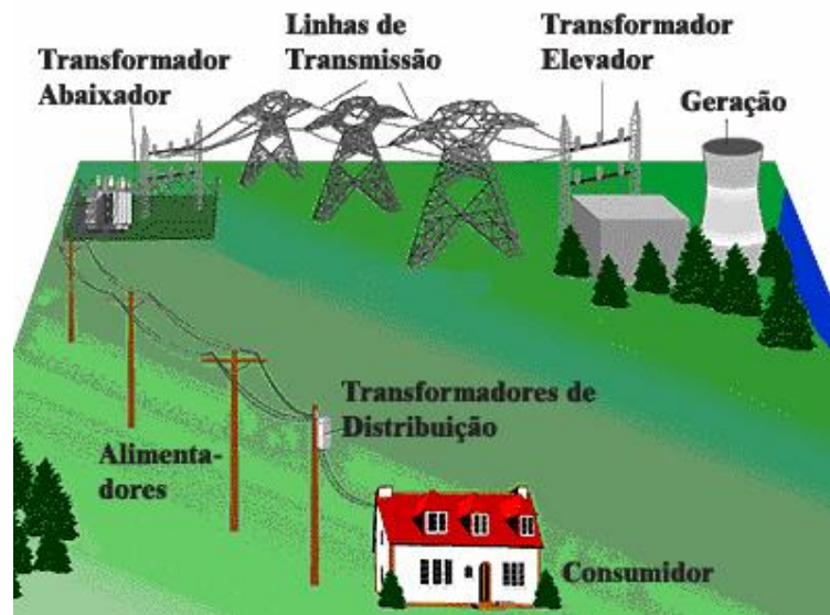
Figura 44: Localização de Transformadores
