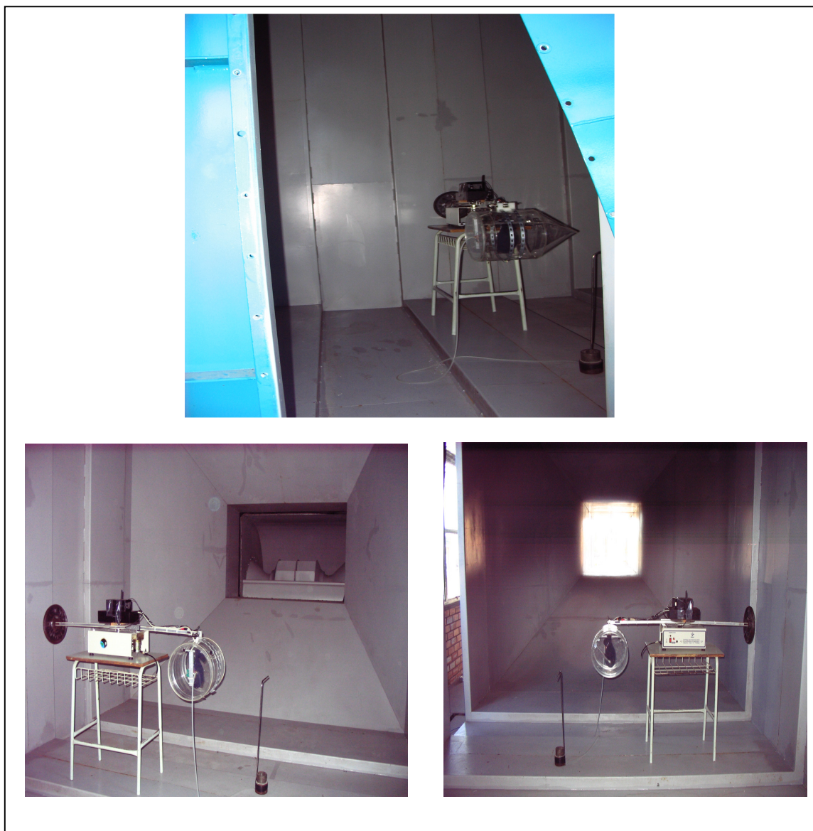
Figura 36 - Imagens da gôndola sendo testada no túnel de vento.
