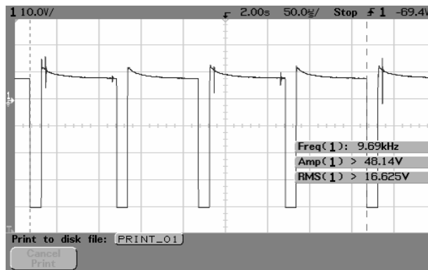
Fig. 3.8 Tensão entre fases do inversor para uma frequência de 10 Hz com um período de amostragem de 50 us/div.
