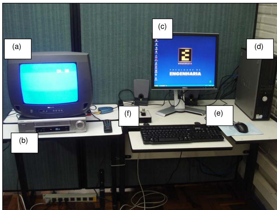
Figura 143 - Unidade de controle da CREC-Ap: monitor de televisão de 14 polegadas (a); videocassete (b); monitor LCD do computador (c); CPU (d); teclado sobre a mesa de apoio (e); tacômetro digital que controla a rotação da cadeira (f).
