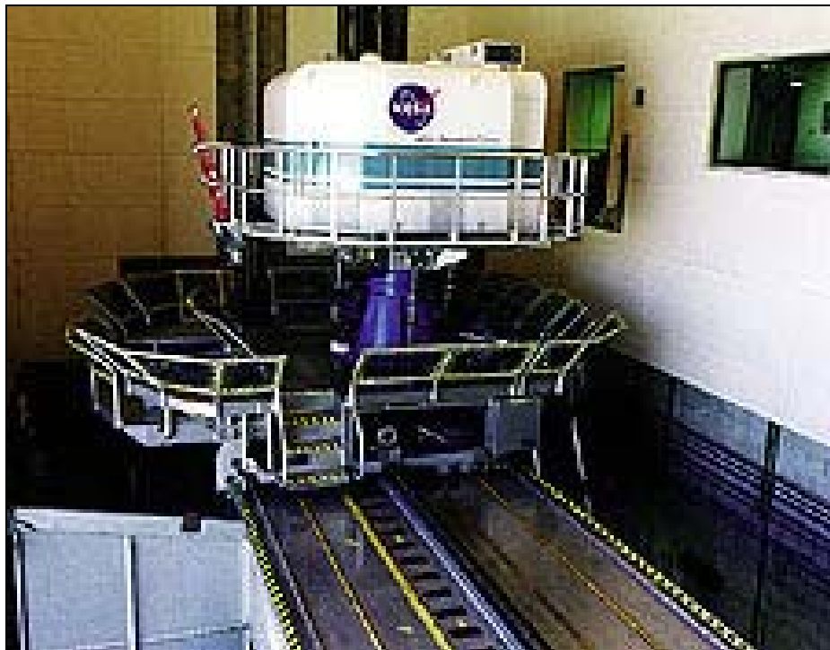
Figura 74 - Cabine intercambiável de vôo de um moderno simulador da NASA. Fonte: http://ffc.arc.nasa.gov/vms
