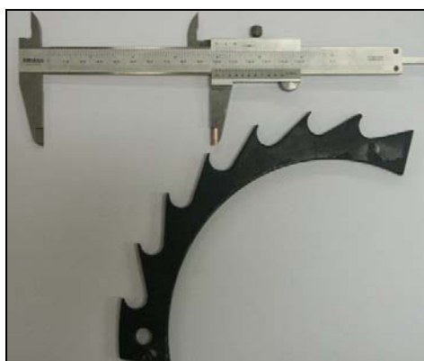
Figura 85 - Trava dentada de aço 1020. Fonte: Gessinger (2005).
