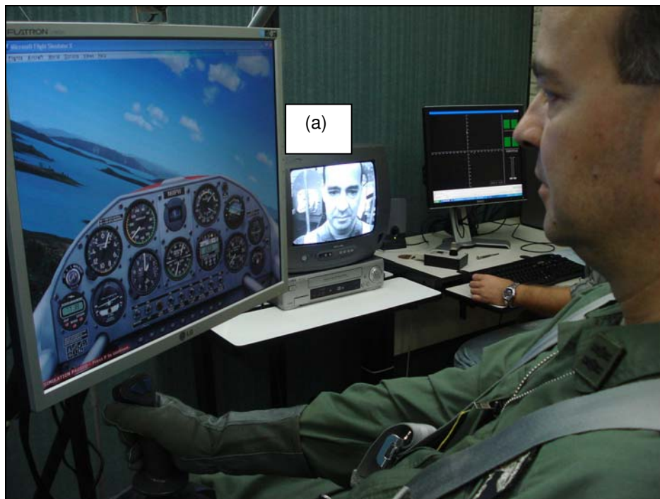
Figura 135 - Monitor de vídeo de 14 polegadas: detalhe do monitor (a) com imagens captadas pela câmera infravermelho, em tempo real, durante teste na CREC-Ap.
