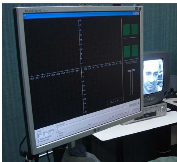
Figura 138 - Imagem do Flight Capture no monitor LCD durante calibragem do manche. Fonte: O autor (2008).
