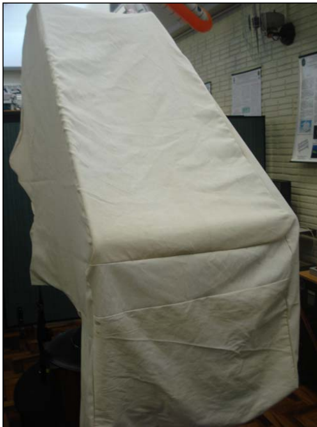
Figura 97 - Vista frontal da cobertura: molde de tecido (brim) da cobertura da CREC-Ap. Fonte: O autor (2008).
