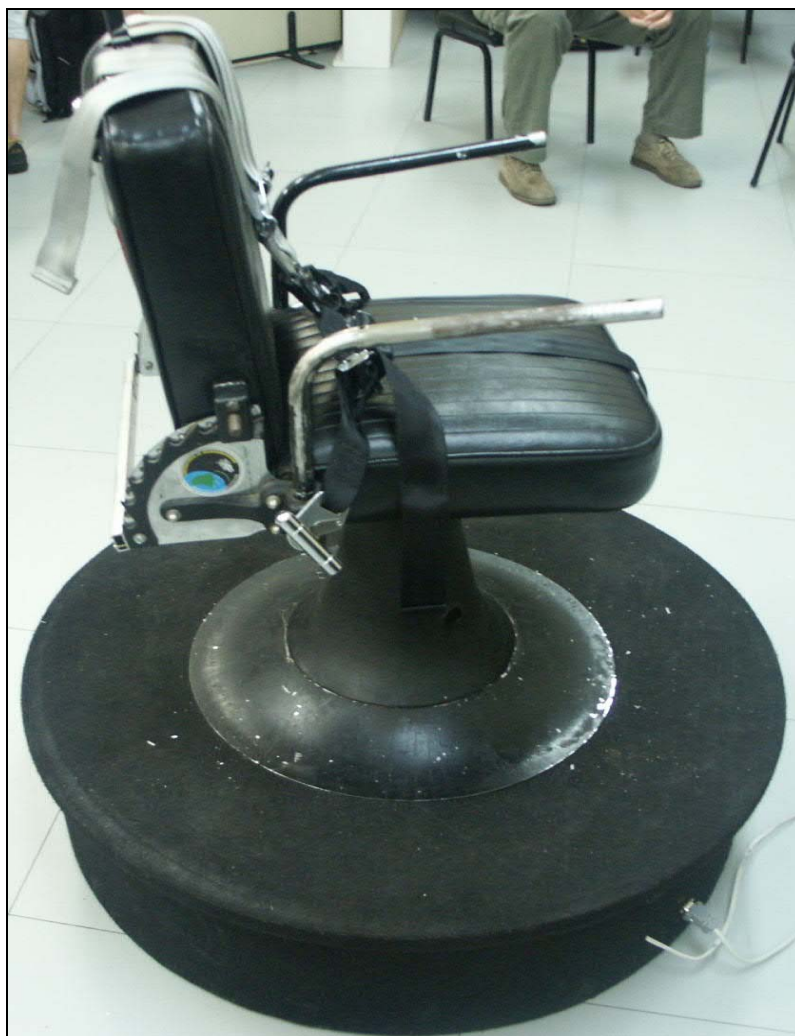
Figura 78 - Cadeira Rotatória Eletricamente Controlada (CREC) modificada: desenvolvida por Gessinger, em 2005, na Pontifícia Universidade Católica do Rio Grande do Sul. Fonte: Gessinger (2005)
