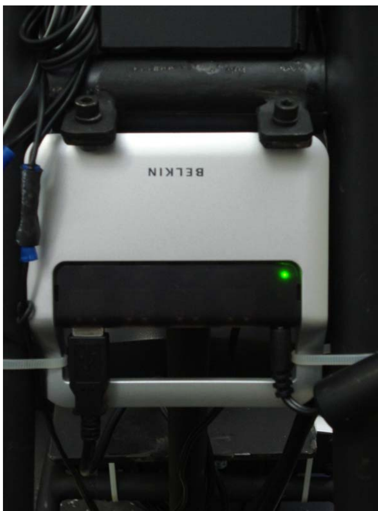
Figura 136 - Unidade Transceptora USB sem fio (WUSB): instalada na parte frontal da cadeira entre os dois tubos de aço, tendo sido fixada com amarras de plástico.
