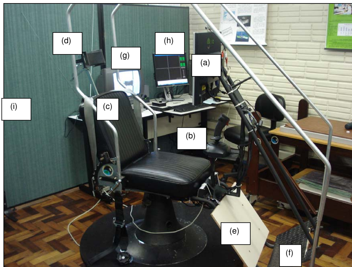
Figura 5: CREC-Ap sem a cobertura. No primeiro plano se identifica: monitor LCD da cadeira com microcâmara (a); manche (b); encosto da cadeira (c); apoio para a cabeça (d); apoio para as pernas (e); apoio para os pés (f). No segundo plano: monitor de televisão (g); monitor LCD do computador da unidade de controle da cadeira (h). Distingue-se, ao redor da CREC-Ap, um biombo forrado com tecido na cor verde (i) apropriado para prover absorção de ruído, tendo sido utilizado de forma a criar um ambiente separado, dentro do laboratório do Centro de Microgravidade da PUCRS, delimitando a área de experimentação. Fonte: Autor (2008). / I-ECRC without cover .
