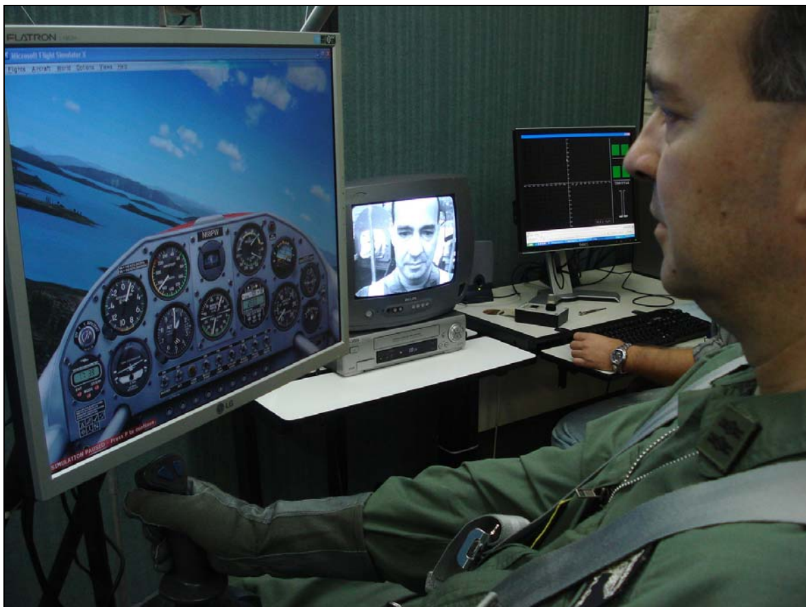
Figura 150 - “Vôo” de teste na CREC-Ap: quantificação da desorientação espacial com captura de imagens pela microcâmara (a), imagens do Flight Simulator X no monitor embarcado (b) e captura em tempo real dos movimentos do manche acompanhados na tela do computador da unidade de controle da cadeira pelo Flight Capture (c).
