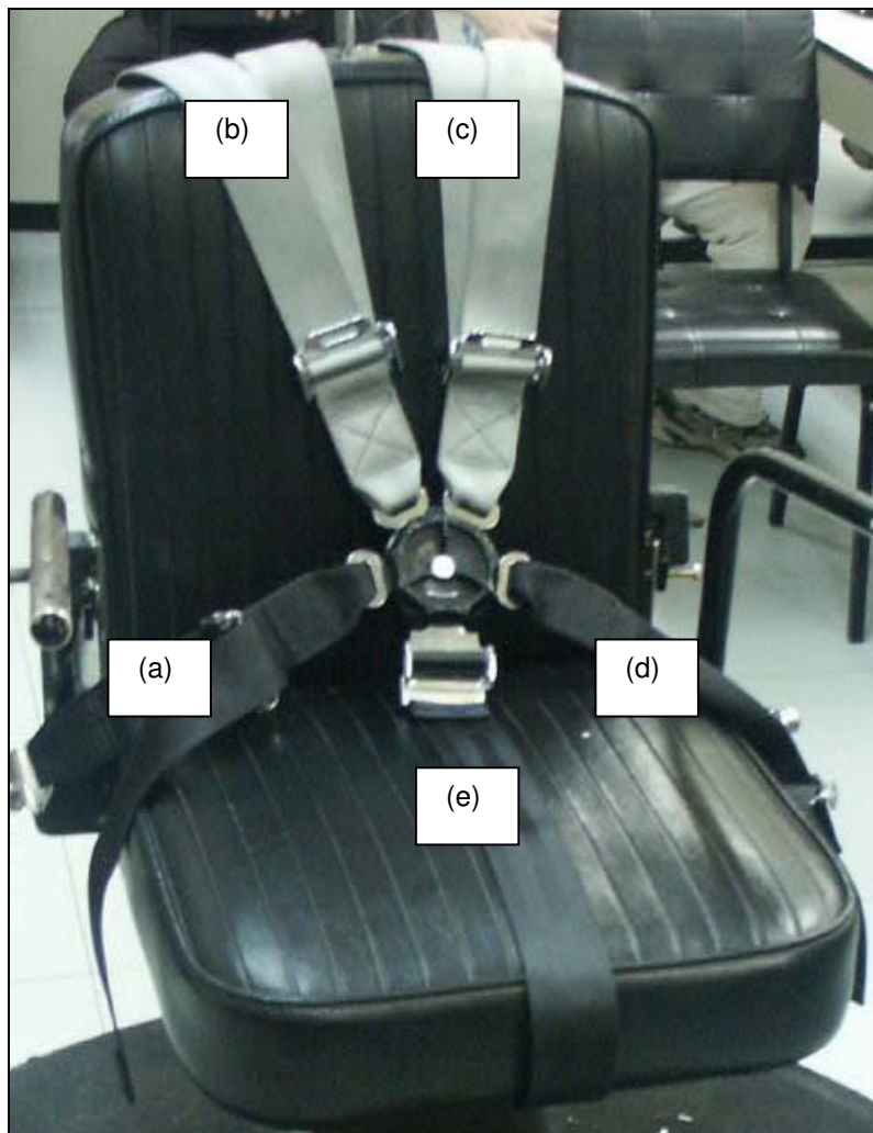
Figura 90 - Cinto de segurança de cinco pontos: (a), (b), (c), (d) e (e) que proporciona maior segurança e conforto para a realização dos testes.
