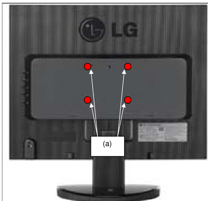
Figura 115 - Vista da parte posterior do monitor: detalhamento da fixação em quatro pontos (a). Fonte: http://www.lg.com.br
