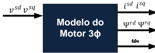
Figura 3.1: Digrama entrada-saída do motor trifásico.
