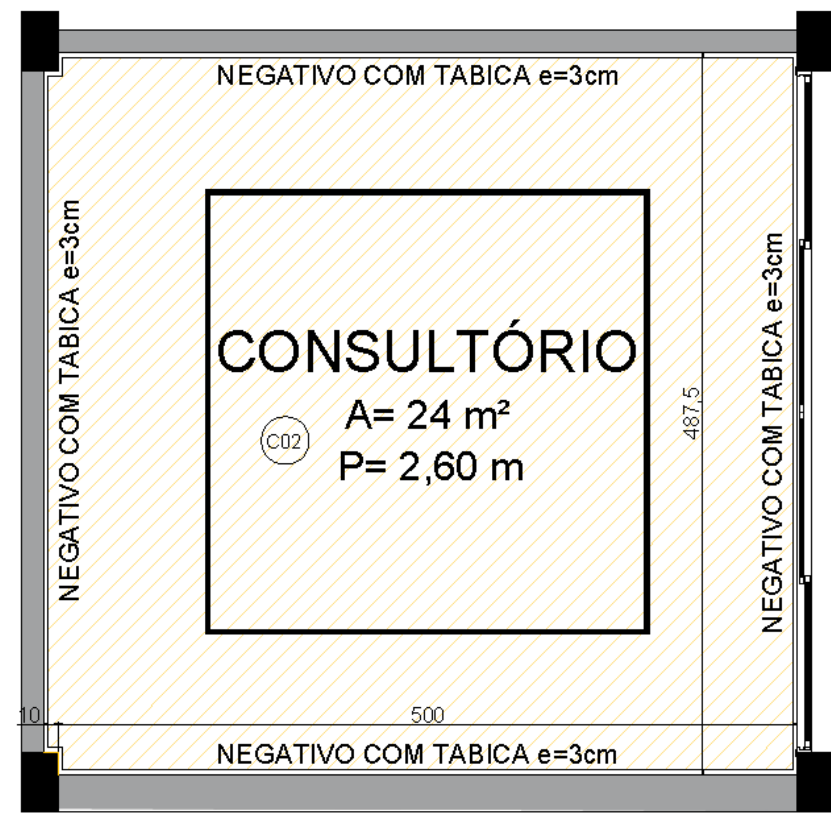
PLANTA DE FORRO ESC.: 1:25
