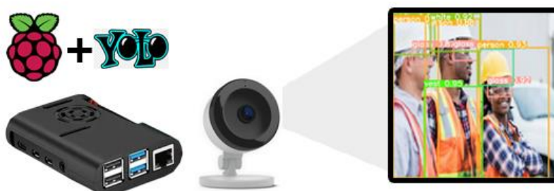
Figura 5 - Sistema embarcado de detecção de EPI's
