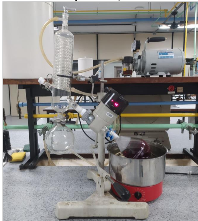
Figura 15 – Extrato de beterraba orgânica em processo de concentração no evaporador rotativo
