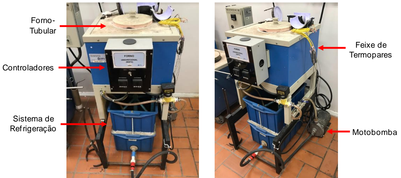
Figura 4.4. Imagens do forno tubular de solidificação unidirecional vertical.
